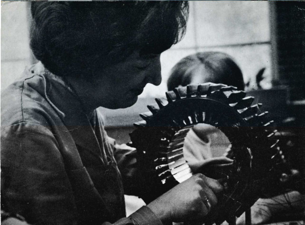
Een wikkelaarster aan het werk met een klein model elektromotor.
